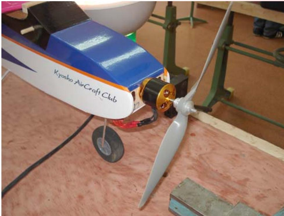
Первое - отказались от установки моторчика внутри фюзеляжа, а для установки БК снаружи пришлось снять шпонку с вала и задвинуть его до следующей насечки под шпонку. В итоге вал оказался с другой стороны мотора.
