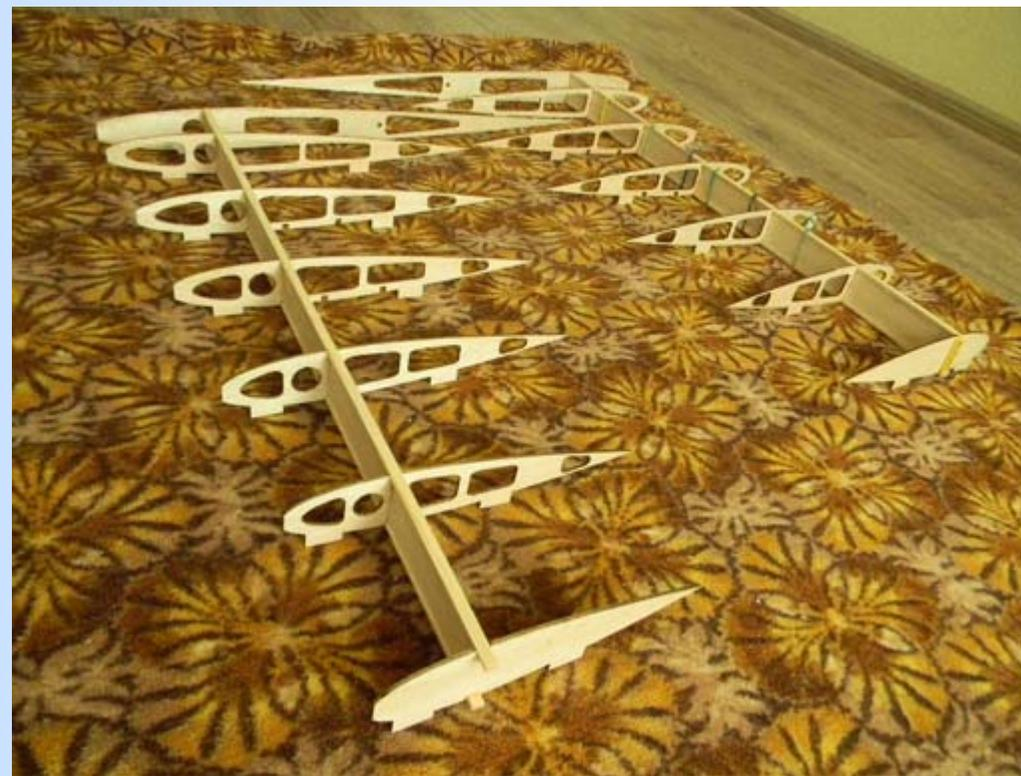
Нервюры вырезал из 3 мм бальзы средней плотности с окнами облегчения. Корневые нервюры выполнены из переклея 3 мм бальзы и 1,5 мм берёзовой трёхслойной фанеры. Вклеил усиливающие колечки из 3 мм лёгкой фанеры в местах вклеивания пеналов для соединительных труб.
