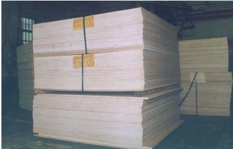
Прочность материала при скалывании достигает 1,6-2 МПа после пребывания в кипящей воде в течение одного часа. При этом уменьшается толщина фанеры. Предел шероховатости такой фанеры составляет 100 мкм при влажности 5-9 %.
