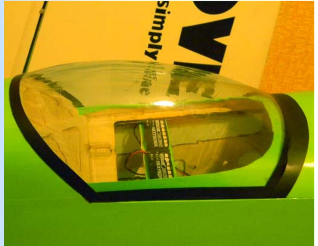
После установки всей комплектухи взвесил самолёт. Вот что получилось: фюзеляж в сборе со всей комплектухой без капота 3278 г, консоль крыла левая 458 г, консоль крыла правая 450 г, капот 230 г, труба соединительная 150 г. Итого сухой вес получается - 4566 г, бак - 330 г, лыжи 144 г. Итого взлётный вес ориентировочно - 5040 грамм. В 4.5 кг веса не уложился, а планировал. Площадь крыльев примерно - 59,2 дециметра. На этом строительство данного самолёта было закончено.
