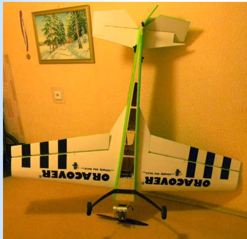
Капот изготовил из 5 слоёв чулок, пропитанных эпоксидкой, на пенопластовой болванке. После шпатлевки покрасил чёрной краской из баллончика (кстати, удобная штука для покраски мелких деталюшек).
