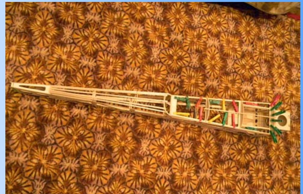
Изготовление крыла. Лонжерон сделал по классической схеме. Полки лонжерона из сосны 8X4 мм. Лобик крыла зашил бальзой 1,5 мм средней плотности. Полки нервюр выполнил из полосок шириной 10 мм и толщиной 1,5 мм также из бальзы. Задняя и передняя кромка крыла выполнена из 3 мм бальзы.
