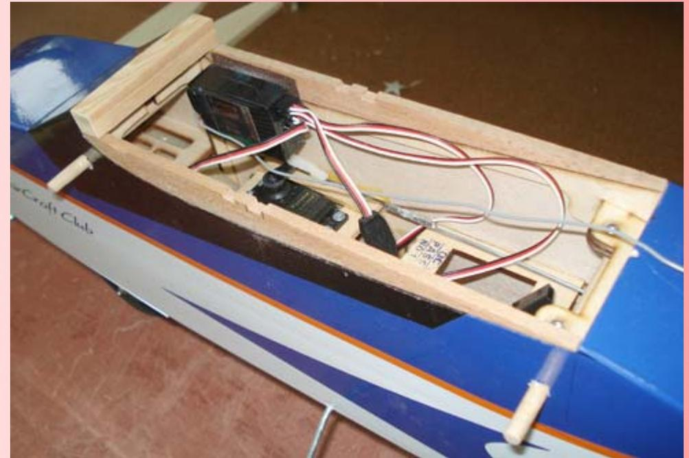
Крепление крыла на резинках, деревянные штыри свинтил с рояля. Для установки крыла на фюзеляж необходимы буковые вставки на клею.
