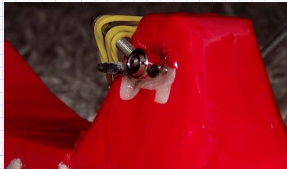
Вторая причина более экзотическая как оказалось, внутренний диаметр трубочки был "только-только" по диаметру проволоки. На морозе трубка съёжилась, трение значительно усилилось, и трубку вывернуло из пенопласта при первой же "конкретной" посадке. Вылечил рассверливанием уже залитой эпоксидкой трубки сверлом +0,2 мм.
